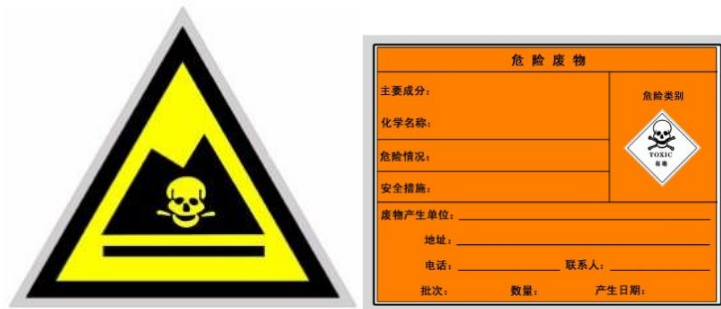
图 3-1 危险废物警告标志牌、危险废物标签
